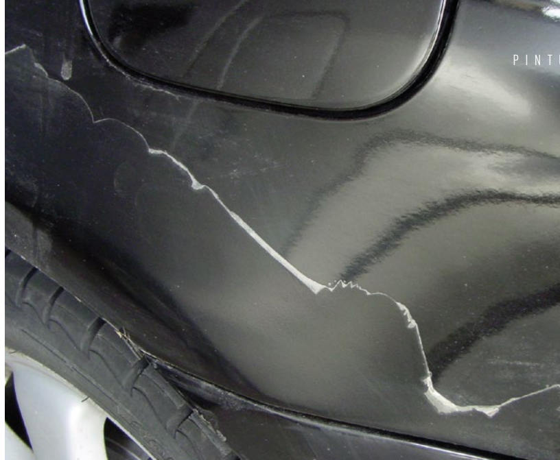
► Desprendimiento de pintura por falta de adherencia
