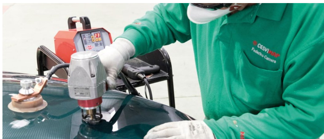
► Extracción de abolladuras con la herramienta AP 95
