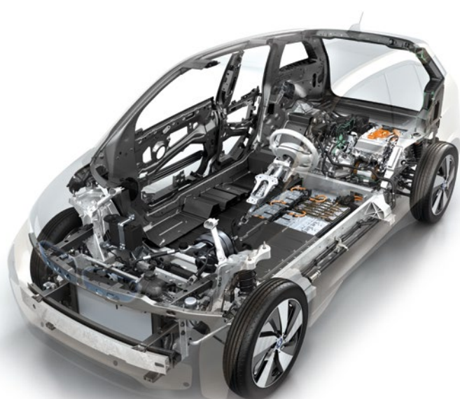
► Estructura y ubicación de la batería
