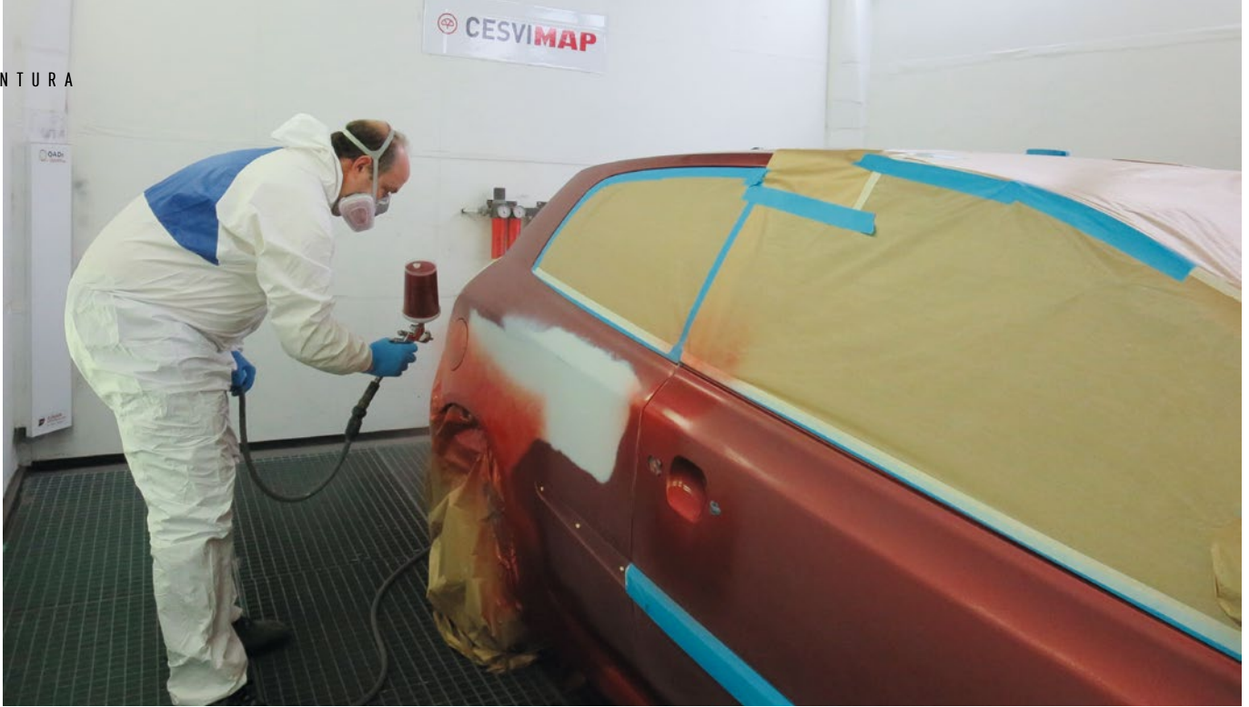
► Aplicación de la base bicapa
